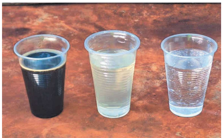
Imagem: amostra de água lixivante, antes e depois do tratamento por osmose inversa.
