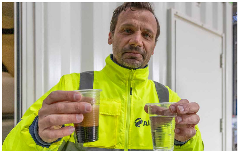
Imagem: Carlos Juncal compara uma amostra de água lixivante, antes e depois do tratamento por osmose inversa.
